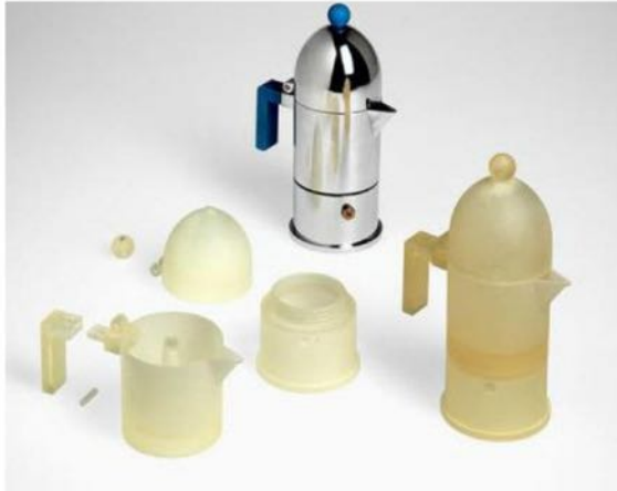
Prototype d'une cafetière Alessi (deux types de plastiques), réalisé en stéréolithographie à l'aide d'une imprimante professionnelle ProJet HD 3000. (Source : 3D Systems)
