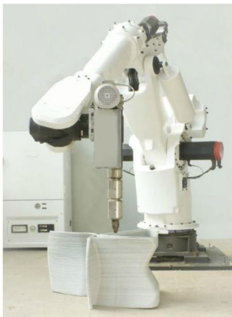
Le robot Endless en pleine impression. (Source : Dirk Vander Kooij)
