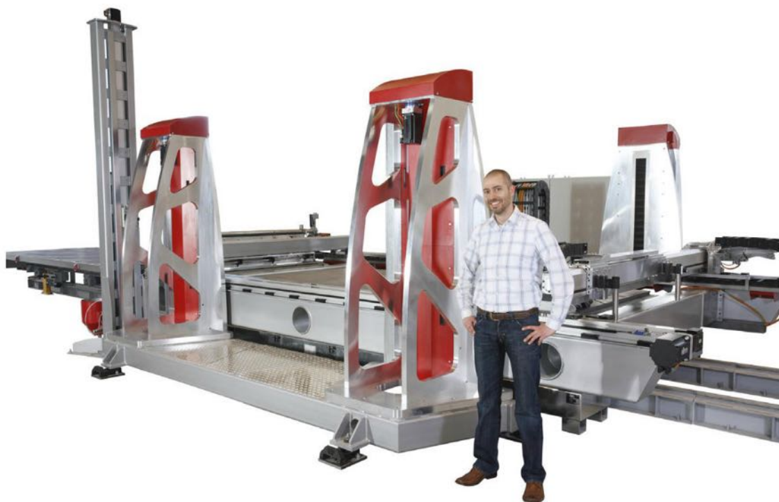
La VX4000, l'une des imprimantes 3D les plus grandes du marché. (Source : Voxeljet)
