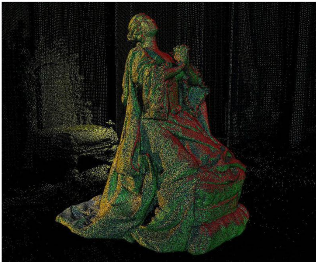
Nuage de points résultant du scan de statues appartenant au décor du spectacle 1789 Les Amants de la Bastille . (Source : Le FabShop – Trimble – 1789 Les Amants de la Bastille – NTCA Production 2012)
