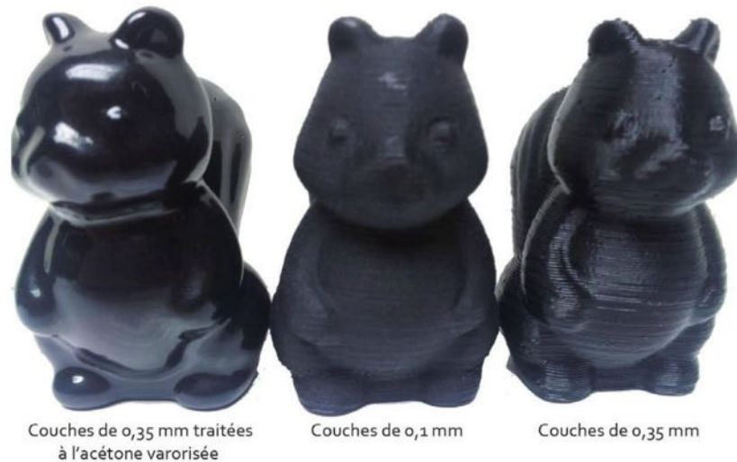
Comparaison des états de finition d'une pièce imprimée sur une RepRap. (Source : Austin Wilson et Neil Underwood, Fablocker)
