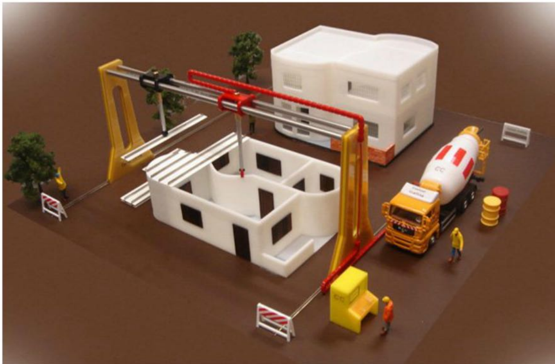
Représentation miniature de l'imprimante 3D de Contour Crafting. (Source : Contour Crafting)
