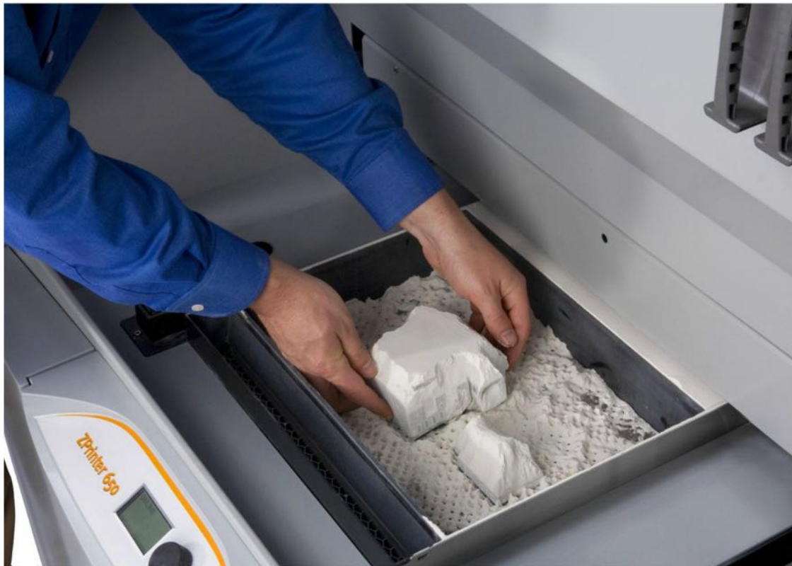
Un objet sort de la poudre après impression par 3DP. (Source : 3D Systems)
