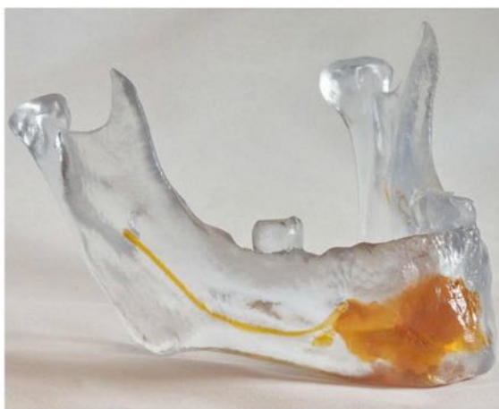
Moulage dentaire réalisé avec le matériau VisiJet Clear à l'aide d'une imprimante ProJet 6000. (Source : 3D Systems)
