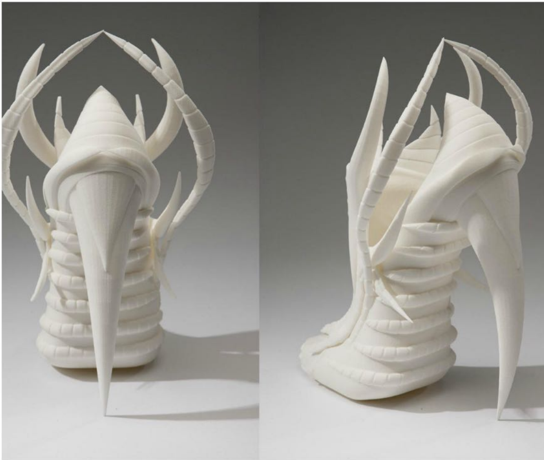
Modèle conceptuel de chaussure imprimé par frittage laser de poudre de polyamide sur une imprimante EOS.
