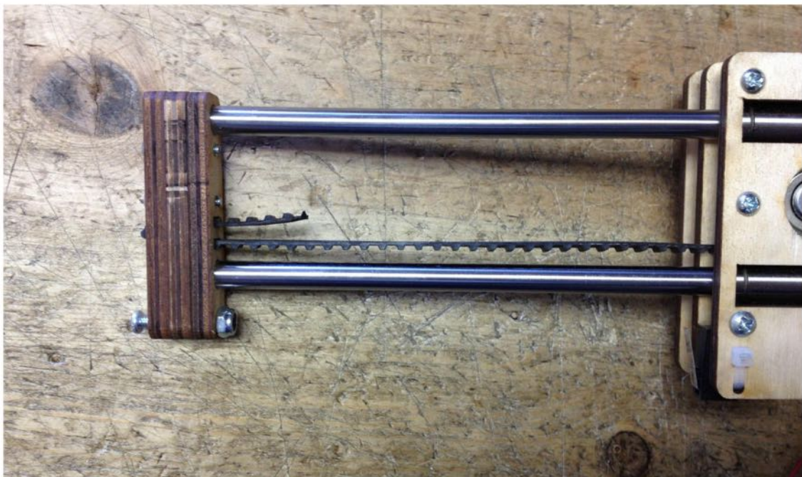
Courroie de transmission bien tendue sur l'axe y d'une Printbot jr. (Source : Printbot jr)
