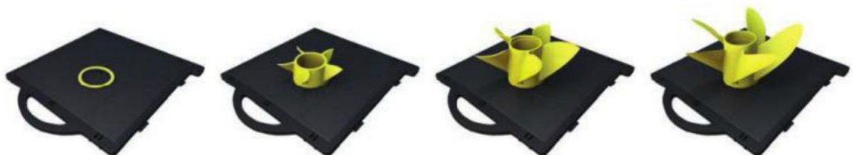
Étapes de l'impression 3D d'une hélice. (Source : Stratasy via CSC)
