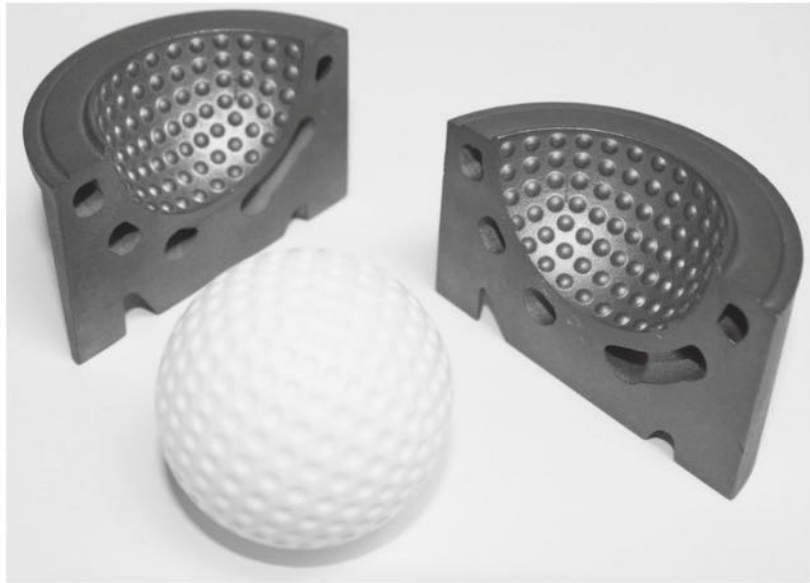
Moule de balle de golf en acier inoxydable, imprimé en 3D par DMLS. (Source : Incept 3D)
