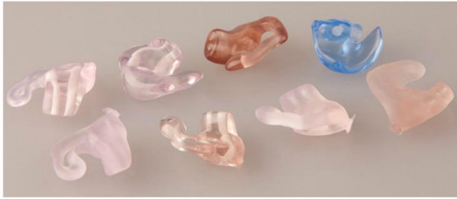
Aides auditives imprimées par DLP sur une machine EnvisionTEC. (Source : EnvisionTEC)
