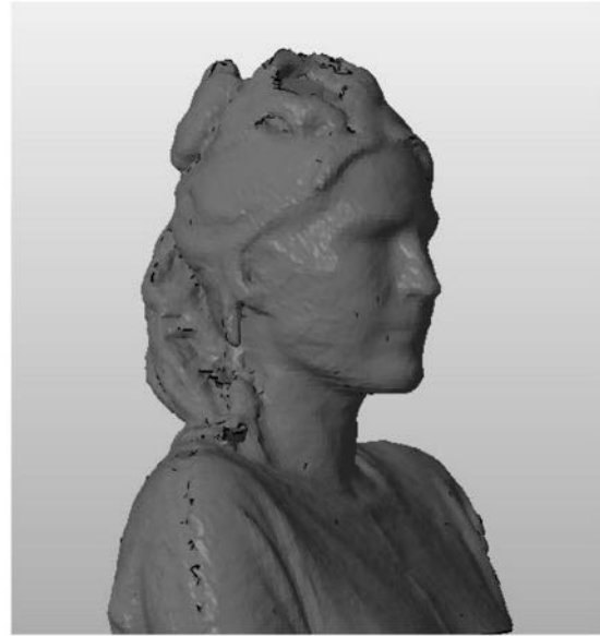
Scan 3D réalisé à l'aide d'une Kinect et du logiciel ReconstructMe. (Source : Le FabShop)
