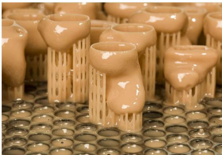
Aides auditives au sortir de l'impression, utilisant les imprimantes danoises Widel. (Source : Christian Sandström / Disruptive Innovation)
