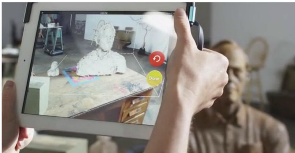
Scan 3D d'une sculpture réalisé avec le Structure Sensor. (Source : Occipital)
