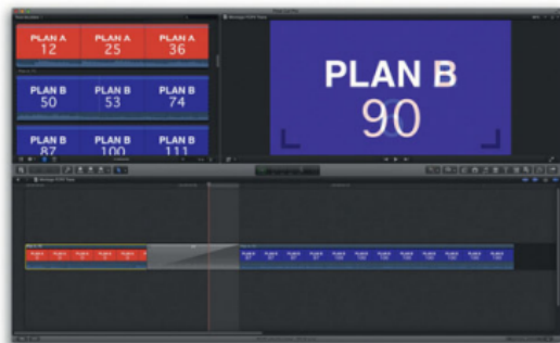
Fig. 6-21. Effet d'une transition en fondu enchaîné où les images du plan A et du plan B se fondent les unes dans les autres, avec une prédominance du plan A au début puis du plan B à la fin. Pour rappel, le plan A se terminait à l'image 5 et le plan B commençait à l'image 90 ; on voit désormais apparaître dans le fondu les images 88 et 89 du plan B et l'image 6 du plan A (soit trois nouvelles images par rapport à notre coupe initiale).
