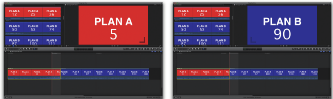
Fig. 6-19. Avant d'appliquer une transition, le passage d'un plan à un autre se fait cut. Ici, la dernière image du plan sortant précède la première image du plan entrant : l'image 90 du plan B succède à l'image 5 du plan A.
