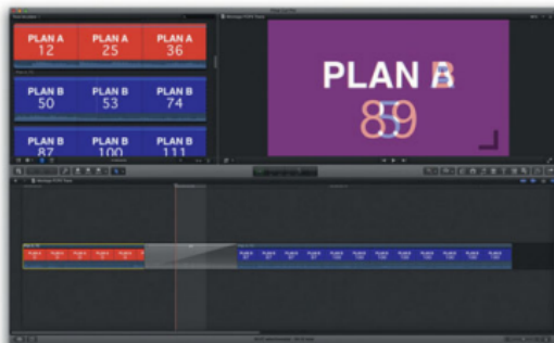
Fig. 6-21. Effet d'une transition en fondu enchaîné où les images du plan A et du plan B se fondent les unes dans les autres, avec une prédominance du plan A au début puis du plan B à la fin. Pour rappel, le plan A se terminait à l'image 5 et le plan B commençait à l'image 90 ; on voit désormais apparaître dans le fondu les images 88 et 89 du plan B et l'image 6 du plan A (soit trois nouvelles images par rapport à notre coupe initiale).
