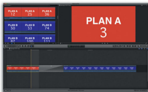
Fig. 6-20. Une transition est appliquée sur la coupe. Le zoom fait apparaître une ombre sous la tête de lecture pour signifier la largeur d'une image : la transition a ici une durée de 3 images (il s'agit d'un exemple car c'est très court !). On voit la dernière image du plan sortant avant que la transition ne commence.
