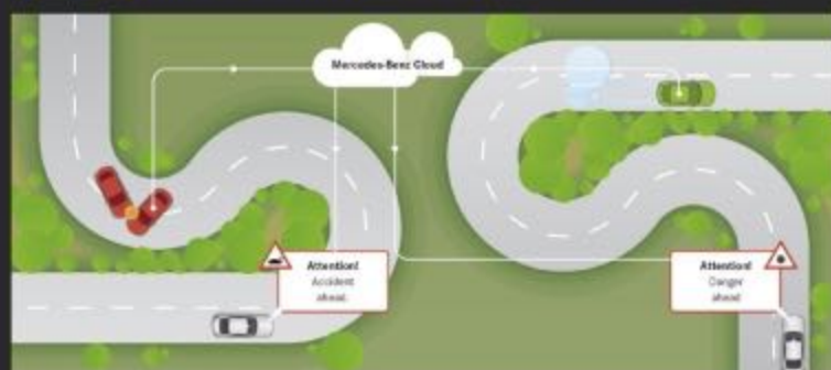
Un cloud permet d'avertir les autres usagers d'un incident.
