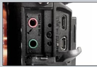
L'entrée micro et la sortie casque d'un côté, les connecteurs "multi" USB et micro HDMI de l'autre sont derrière des caches sur charnière souple.
