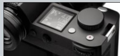
*C'est du massif mais aussi de la belle mécanique. Notez, sous l'écran secondaire, le petit joystick servant à positionner le collimateur AF et à naviguer dans les menus.*
