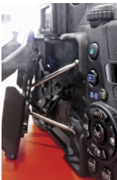
Le "full frame" de Pentax s'annonce costaud : sa construction massive offre une belle prise en main, et ses touches révèlent des fonctions intéressantes : HDR, Wi-Fi, GPS, crop au format APS-C, double slot SD, réglages utilisateur au nombre de 5, et cette troisième molette en haut à droite dont on ne connaît pas encore la fonction... Mais le plus étonnant reste l'écran monté sur quatre tiges, orientable sous tous les axes.
