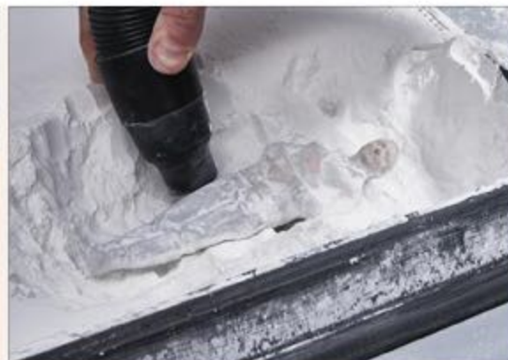
À l'aide d'un mini-aspirateur, le gros de la poudre qui entoure le modèle imprimé est éliminé.
