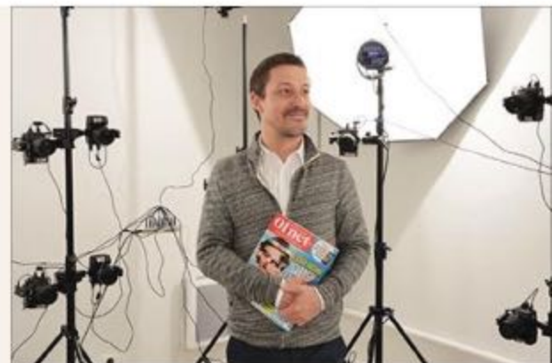
Plus de 50 appareils photo se déclenchent simultanément pour prendre le modèle sous tous les angles.
