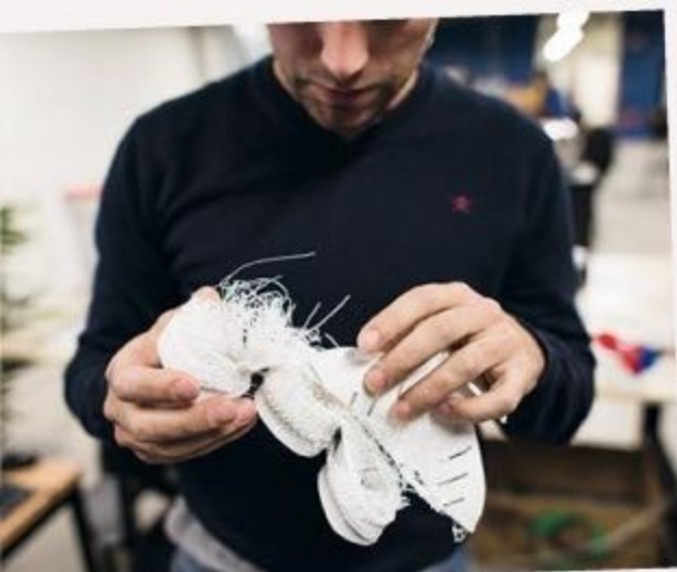
Bobine mal engagée, erreur du logiciel... les bugs obligent souvent à s'y reprendre à plusieurs fois.
