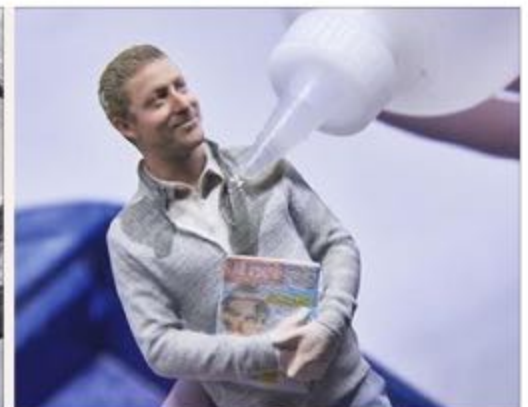
Pour solidifier la statuette, et dévoiler les couleurs, une colle ultraforte est appliquée.
