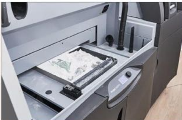
Cette machine (75 000 €) imprime en couleurs à partir d'un matériau à base de gypse.
