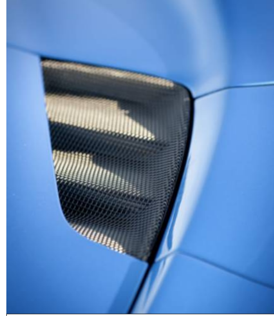
La 488 Spider met l'aérodynamique au cœur du débat. Aussi bien pour l'appui que pour l'échange calorifique, à l'image de la prise d'air sur l'aile arrière.
