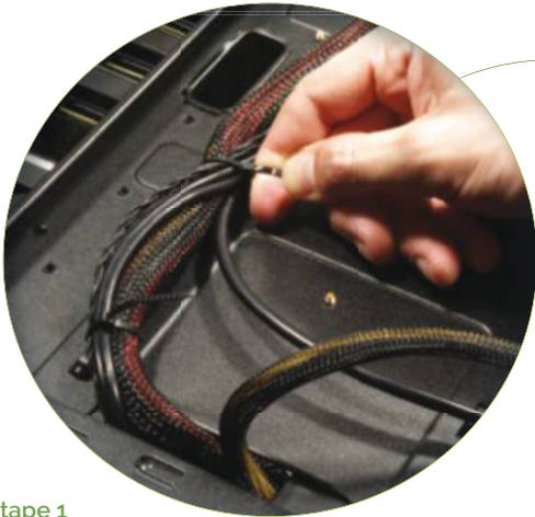
Étape 1 Serrez les câbles pour simplifier le passage de l'air.
