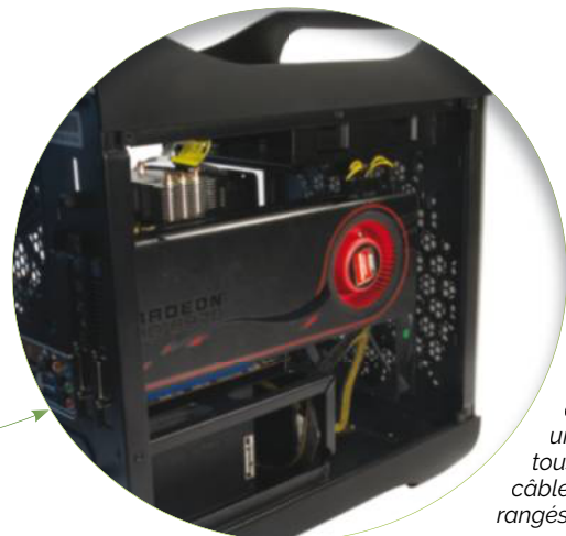
Étape 1 Rangez tous les câbles avant d'installer une carte graphique ou une carte d'extension. Essayez de profiter d'une alimentation modulaire et utilisez des serre-câbles.
