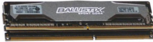
■ Une barrette de mémoire DDR4 sur une barrette de DDR3 : on peut noter le détrompeur différent et la forme courbée.
