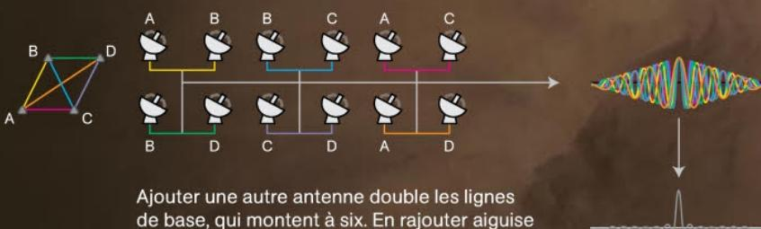
Ajouter une autre antenne double les lignes de base, qui montent à six. En rajouter aiguise davantage le signal et réduit le bruit.
