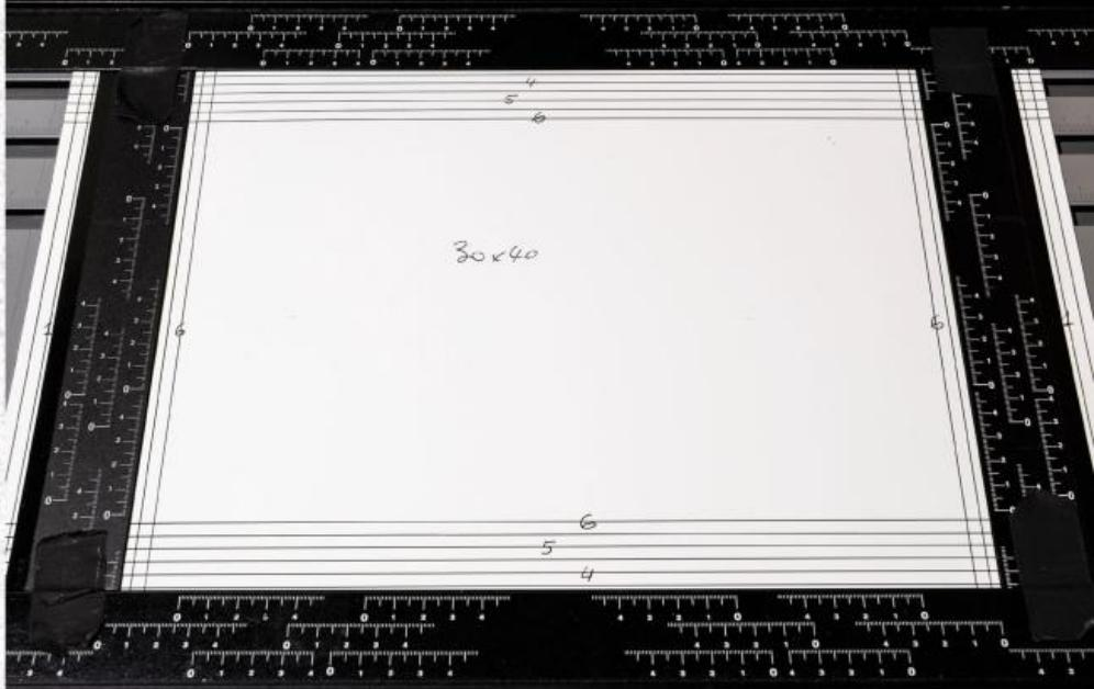
Placé sur le margeur, le gabarit permet d'ajuster exactement les marges, tout en vérifiant que les lames sont d'équerre.
