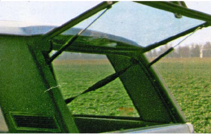
Le hayon s'ouvre en deux parties. La vitre constituant la moitié haute se trouve assistée par deux vérins.
