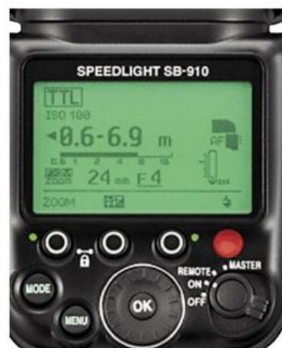
L'afficheur arrière de ce flash indique la plage de distance utilisable lorsque la tête-flash est réglée sur 24 mm : à f:4, la portée est de 6,9 m, soit un NG de 28 m environ.
