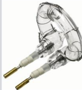
Tube éclair d'un flash de studio : le xénon contenu dans une ampoule s'ionise suite à une décharge électrique dans le conducteur qui cerce cette dernière. La forme torique de ce tube permet de placer en son centre une lampe (halogène) "pilote", permettant de prévisualiser l'effet de l'éclair.
