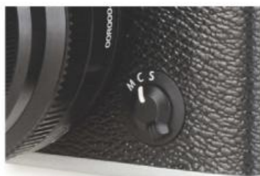
Marque de fabrique de Fuji, le très pratique sélecteur de mode AF (Manuel, Continu, Single).
