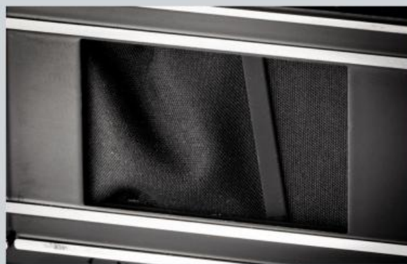
L'obturateur (à rideau à translation horizontale) de mon vieux Olympus OM20 est plus que mal en point...
