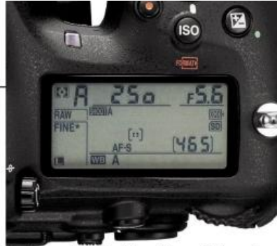
La vitesse peut se régler à la molette : on n'a alors accès qu'aux valeurs entières. Le réglage à la molette permet, en revanche, d'accéder aux 1/3 de valeurs.
