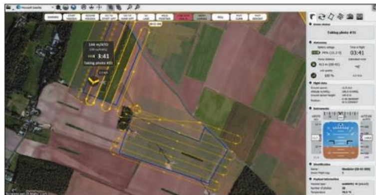
L'interface d'eMotion intègre différents instruments de vol, dont l'altimètre et l'horizon artificiel.
