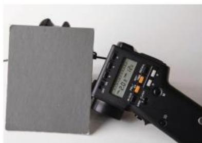
La mesure réfléchie (ici réalisée avec un spotmètre indépendant) prend en compte le coefficient de réflexion du sujet mesuré. Quand c'est possible (comme ici en studio), il peut être utile d'effectuer cette mesure sur un carton gris (à 18 %), ce qui permet de s'affranchir des caractéristiques du sujet.
