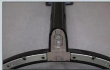
L'écran est fourni avec un pied détachable. Ses deux boulons de fixation paraissent un peu sous-dimensionnés, mais l'ensemble pied-colonne tient bon.
