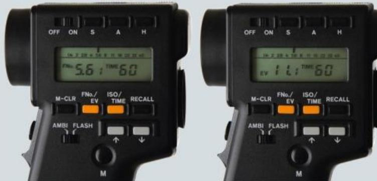
Le posemètre des appareils photo ne donne pas cette indication mais les cellules externes le permettent : on peut afficher l'Indice de Lamination (IL ou EV). On vérifie avec  $n = 5,6$ ,  $t:1/60$  que  $IL$  vaut  $11$  pour 100 ISO grâce à la relation  $2IL = n^2 / t$ .
