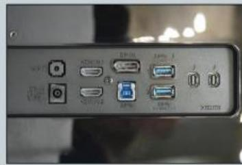
Sur l'arrière de l'écran, les connexions sont bien pourvues : Display-Port, HDMI, USB 3.0 (une prise montante et deux sortantes), 2 Thunderbolt, une sortie casque.
