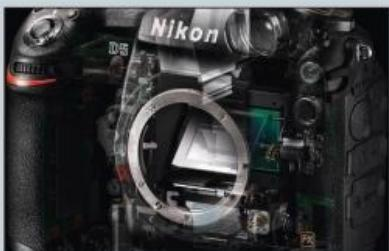
Le mécanisme de visée et d'obturation a été revu, avec des miroirs primaire et secondaire non solidaires. Résultat, on garde une bonne visibilité au viseur même en mode rafale.
