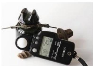
La mesure incidente permet de mesurer directement la quantité de lumière parvenant au sujet, en s'affranchissant de ses caractéristiques. Elle est particulièrement utile pour les sujets hors normes.
