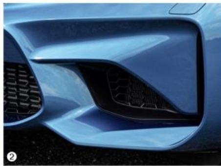
1- Les jantes de 19 pouces sont montées de série et le freinage est renforcé. 2- Le spoiler avant a été totalement repensé pour les besoins du refroidissement. 3- M2, c'est quand même plus sympa que 218d, non ? 4- Les projecteurs bi-xénon sont livrés de série, de même que les lave-phares.
