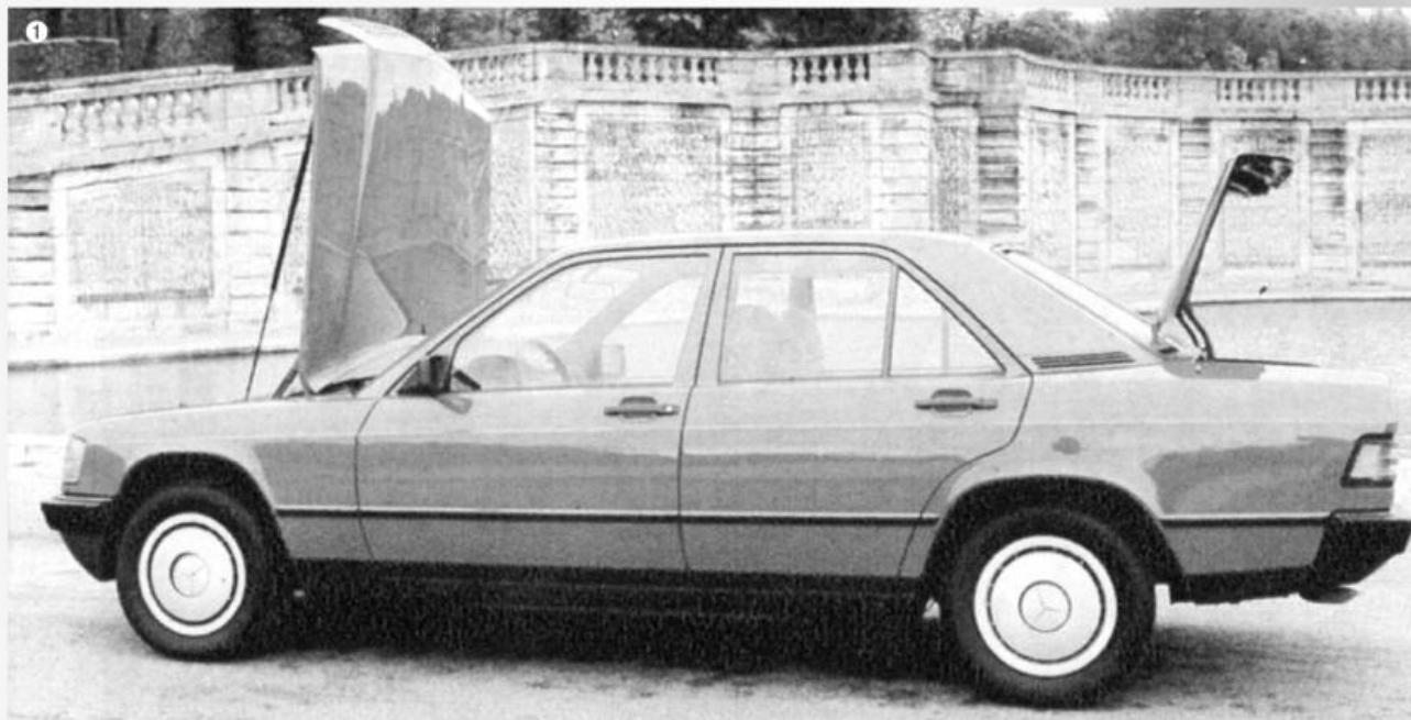
1- Le capot, qui s'ouvre dans le mauvais sens face au vent, peut se relever jusqu'à la verticale. 2- Les places avant sont justes au niveau de la garde au toit, et celles situées à l'arrière manquent d'espace aux jambes.
