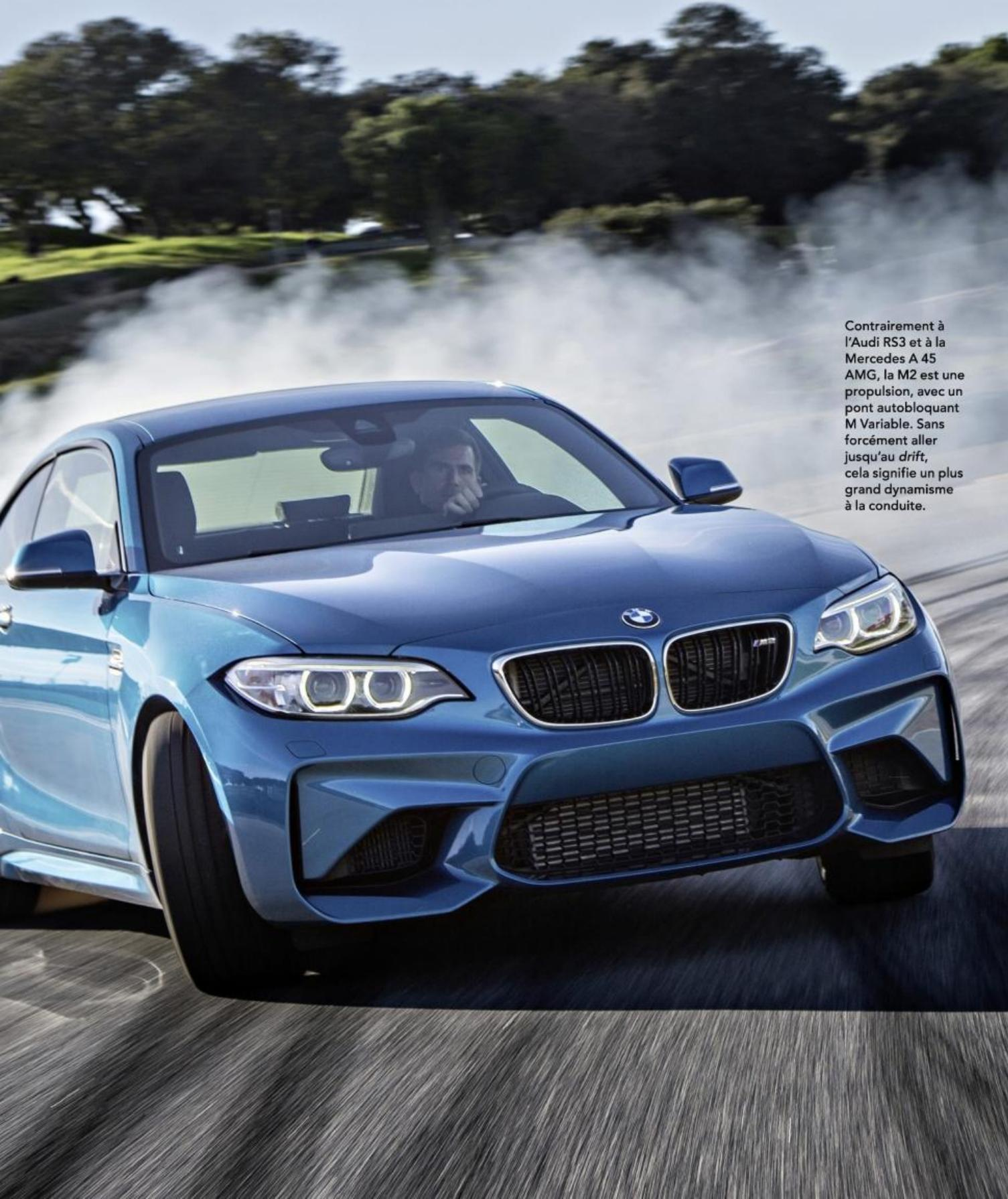
Contrairement à l'Audi RS3 et à la Mercedes A 45 AMG, la M2 est une propulsion, avec un pont autobloquant M Variable. Sans forcément aller jusqu'au drift, cela signifie un plus grand dynamisme à la conduite.
