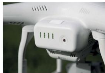
À droite - Les batteries, de type "lipos", sont généralement dans un format propriétaire. Leur durée de vie est de l'ordre de 100 cycles. La présence de leds informe sur l'état de charge des accus.
