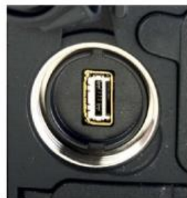
La prise du module Wi-Fi accessoire (WT5 ou WT6) se situe sur le côté du boîtier.
