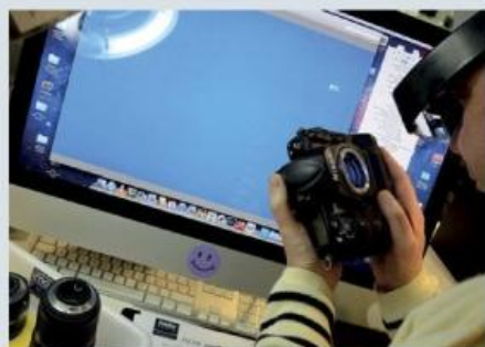
Les boîtiers sont inspectés, nettoyés et remis à neuf, puis le technicien vérifie le compteur interne (nombre total de déclenchements).
