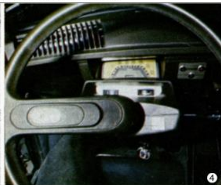
1- Les phares à iode sont proposés en option. 2- La calandre, légèrement retouchée, comporte une barrette au niveau des chevrons. 3- La Super, c'est une Ami 8 avec le bloc de la GS 1015 cm 3 ! 4- Le volant monobranche de la Super est d'un diamètre plus petit que sur l'Ami 8. 5- Une grosse molette située sous le tableau de bord permet de régler les phares.
