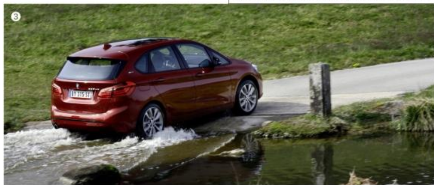
1- Le 225xe n'a pas droit à la BVA8, mais celle-ci n'est pas moins douce. 2- Brancher le 225xe est un jeu d'enfant. Il faut ensuite patienter entre 2 h 15 et 3 h 15. 3- Le 225xe n'est pas un 4 x 4 avec transmission intégrale, mais il est 4 roues motrices : le moteur électrique entraîne le train arrière.
