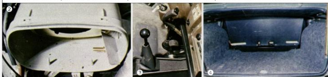
1- La Super hérite de la caisse de l'Ami 8 et ne se montre guère plus habitable, que ce soit à l'avant ou à l'arrière. 2- Le filtre à air est doté d'une position été-hiver automatique. 3- Contrairement à l'Ami 8, la Super hérite d'un classique levier de vitesses au plancher. 4- Le coffre est peu accessible avec son ouvrant quasi-vertical, comme sur la GS.
