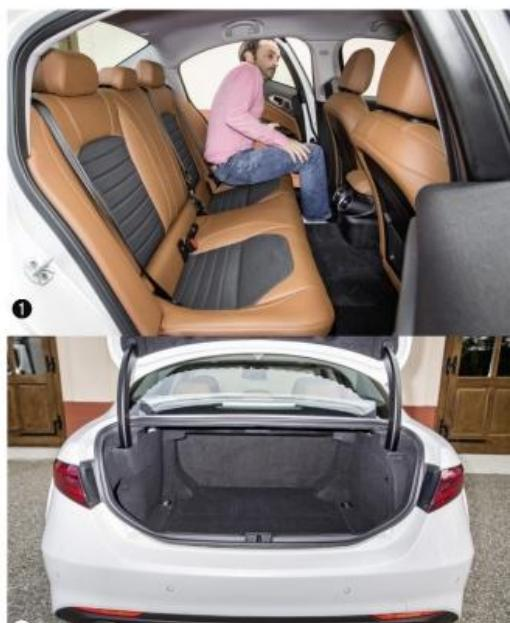
1- Seuil de porte étroit et pavillon cintré, l'accès à la banquette n'est pas aisé. 2- Si le coffre propose un volume largement suffisant et cache sous une trappe la batterie pour la répartition des masses, les dossier de banquette sont rabattables... contre 250 € ! 3- Avec l'option 18 pouces, les pneus sont à roulage à plat.
