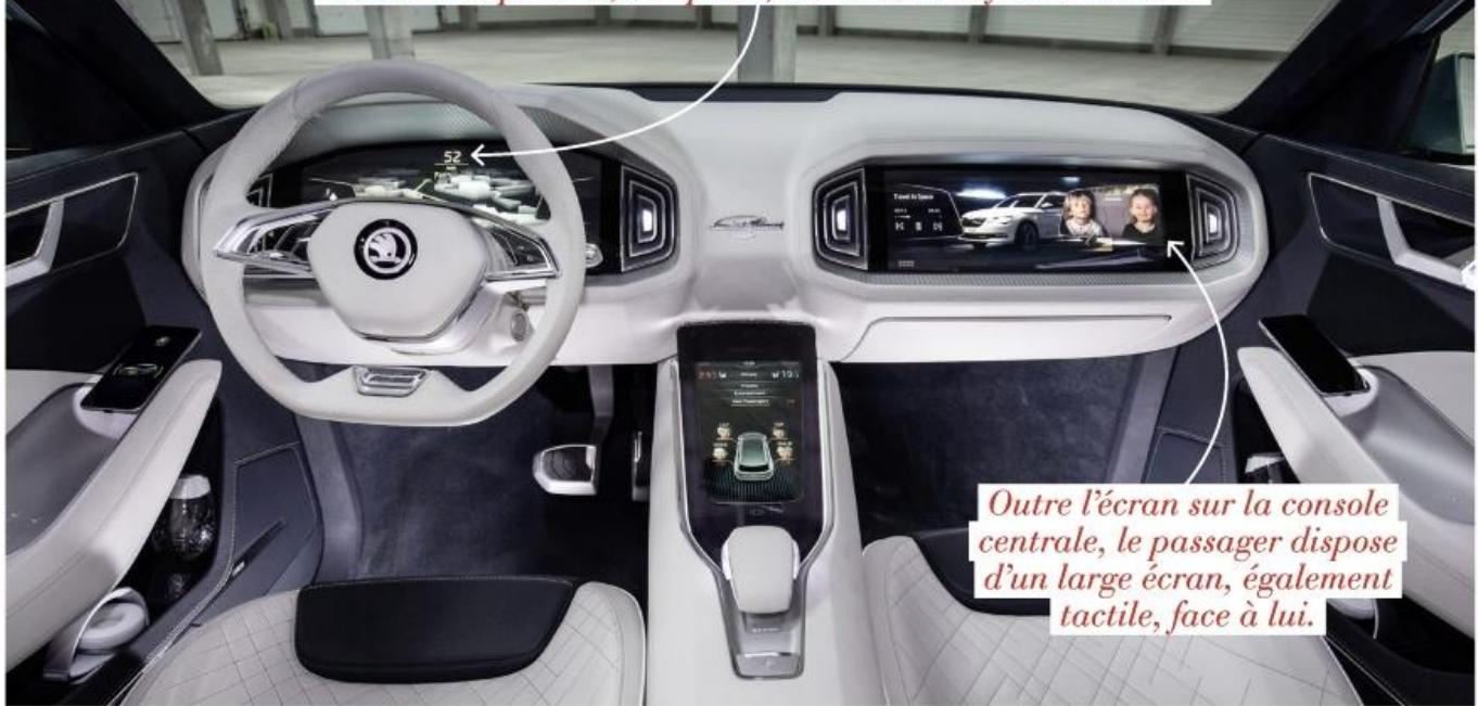
*Outre l'écran sur la console centrale, le passager dispose d'un large écran, également tactile, face à lui.*
