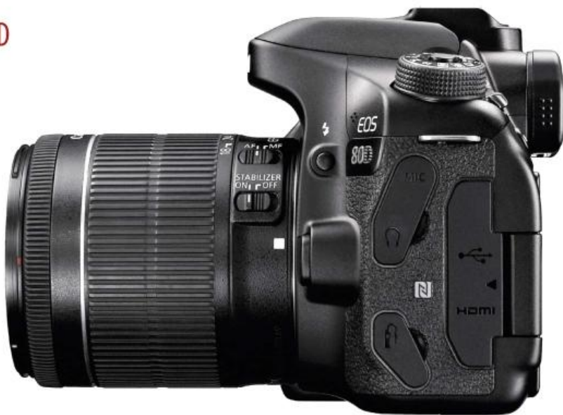
Le 80D ici accompagné de son nouveau zoom 18-135 mm f:3,5-5,6 IS et son nouveau moteur autofocus USM silencieux. On note sur le côté de l'appareil les connexions dont la nouvelle prise casque.
