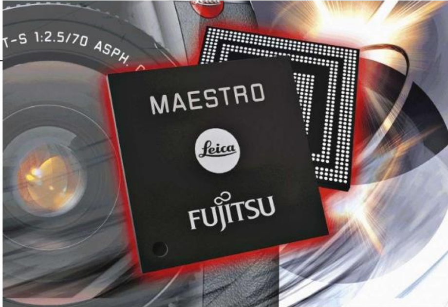
Le circuit de traitement d'image Maestro utilisé dans le Leica S est une déclinaison du Milbeaut de Fujitsu.
