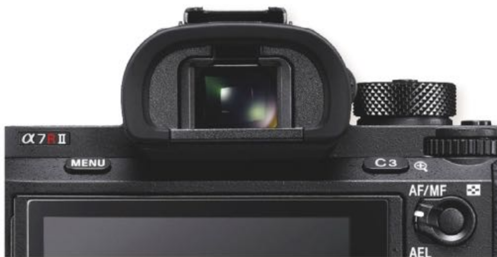
L'Alpha 7R II possède un viseur électronique. La lentille de l'oculaire de visée est un peu plus grande que sur un reflex (les deux appareils sont à la même échelle) et surtout le bossage est bien moins proéminent (pas de prisme à loger).
