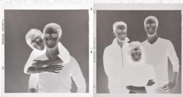
Film Kodak TMax 400. Lors de la même séance de prise de vue, en 2015, le film de gauche n'avait pas dépassé sa date limite d'utilisation. À droite, le film était périmé depuis deux ans. Celui-ci montre, avec le même temps de développement que le premier, un voile de fond plus prononcé et un contraste plus faible. Rolleiflex 2,8 FX.
