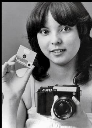
Les tout premiers appareils photo comme le Sony Mavica (MAGnetic VIdeo CAmera) de 1981 (datation à la coupe de cheveux...) utilisaient des disquettes de 2" pouvant contenir 25 images de 570x490 pixels issues d'un capteur vidéo. Par la suite, les disquettes informatiques de 3,5" ont été utilisées pour pouvoir être lues directement par les ordinateurs.
