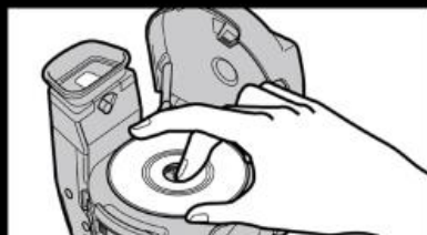
Certains appareils ont intégré des mini-CD réinscriptibles pour enregistrer les images. Le Sony MWC CD1000, à deux millions de pixels pouvait enregistrer 160 photos Jpeg sur un disque de 8 cm de diamètre (ZIO Mo).
