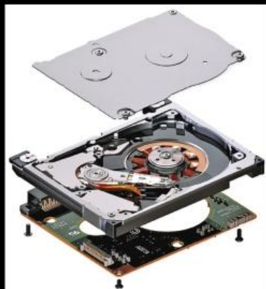
Les microdrives, aujourd'hui obsolètes pour la photo numérique, pouvaient contenir jusqu'à 8 Go de capacité de stockage sur un disque de 1" inséré dans une enveloppe CompactFlash type II (Document Hitachi).
