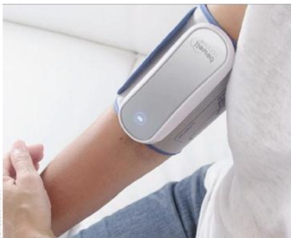
Le tensiomètre, connecté en Bluetooth, effectue trois mesures, puis les envoie, via l'appli MyTensio, au smartphone pour analyse.
