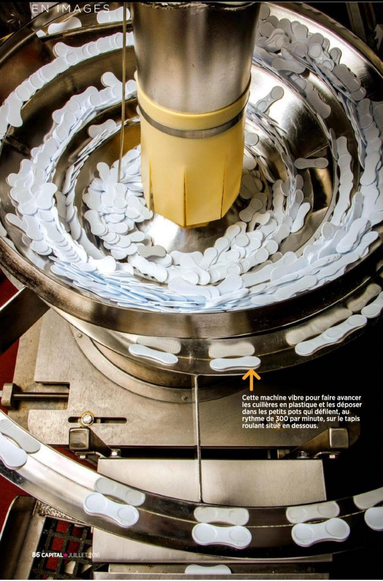
Cette machine vibre pour faire avancer les cuillères en plastique et les déposer dans les petits pots qui défilent, au rythme de 300 par minute, sur le tapis roulant situé en dessous.
