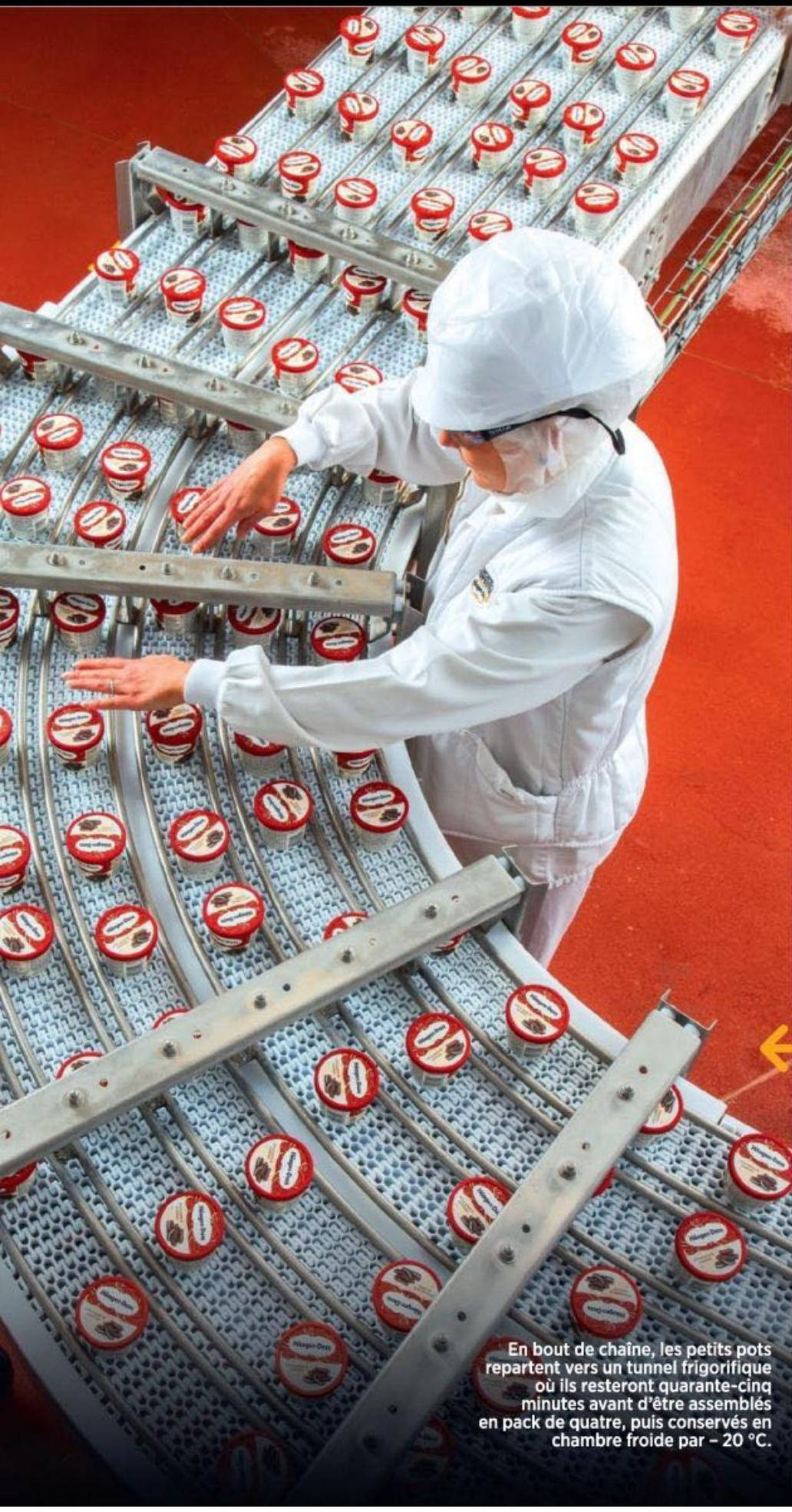
En bout de chaîne, les petits pots repartent vers un tunnel frigorifique où ils resteront quarante-cinq minutes avant d'être assemblés en pack de quatre, puis conservés en chambre froide par - 20 °C.
