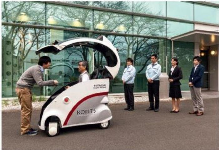
Ropits est une chaise roulante autopilotée réservée aux trottoirs. GPS et lasers lui permettent de véhiculer son passager en contournant les obstacles.
