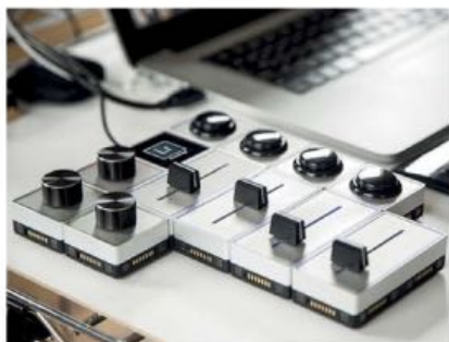
Différentes briques de la Palette Gear assemblées pour piloter le logiciel Lightroom (icône sur l'écran OLED). On peut configurer l'éclairage de chaque brique, comme ici un potentiomètre en vert et l'autre en rouge.
