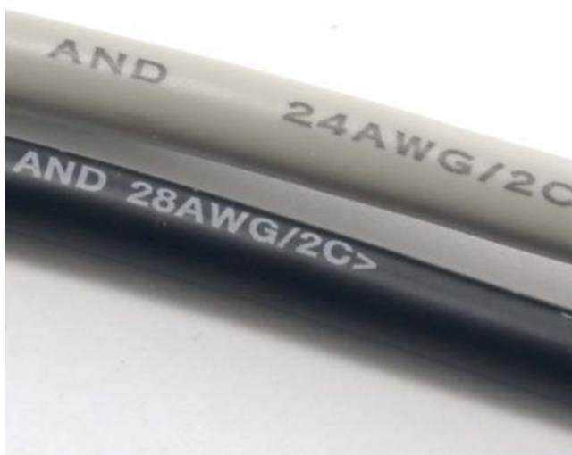
Deux câbles Mini-USB. Le premier (gris) date de 2009 et utilise des conducteurs 24 AWG pour l'alimentation. Le second, plus récent, se contente de 28 AWG.
