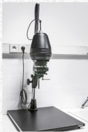
Le Rohen NA66 , fabriqué en France jusqu'au début des années 2000, est l'exemple typique de l'agrandisseur à condenseur. Robuste, simple, il s'utilise avec des filtres, disposés sous l'objectif, pour le papier à contraste variable.
