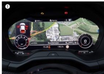
1- Le Virtual Cockpit (520 €) permet d'afficher les informations de son choix au niveau des compteurs. La carte du GPS est d'une précision et d'une netteté impressionnantes. 2- La boîte manuelle à 6 rapports est une alliée efficace du 3 cylindres turbo essence lors des relances. Ferme, dotée d'un verrouillage franc et d'un passage fluide des rapports, elle est agréable.
