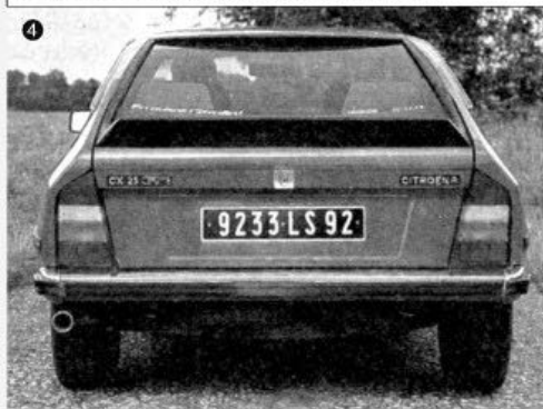
1- Le coffre est profond mais souffre de l'absence d'un hayon, ce qui complique son accessibilité. 2- La CX GTI "25" se contente du vieux 4 cylindres maison réalisé à 2500 cm³. Il développe 138 ch DIN à 5000 tr/mn. 3- En plus d'appuie-tête, les places arrière bénéficient de stores individuels rétractables. 4- La sportive variante GTI a droit à un becquet arrière.
