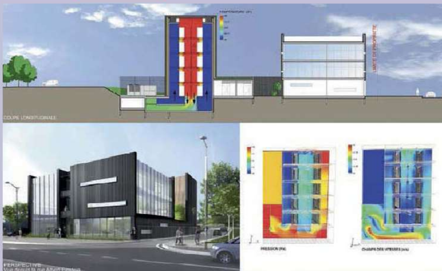
Marilyn, le centre de données vertical de Celeste s'appuie sur les lois de la thermodynamique pour réduire sa consommation électrique. Et il réinjecte les calories dissipées par les serveurs dans les bureaux.
