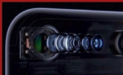
L'objectif de l'iPhone 7, équivalent 28 mm, possède désormais 6 lentilles.
