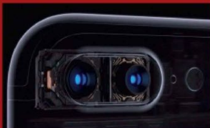
L'iPhone 7 Plus bénéficie d'un deuxième objectif, équivalent 56 mm.
