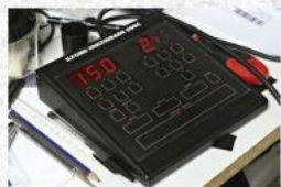
La console de la tête Ilford contrôle à la fois le temps d'exposition (ici 15 secondes) et le contraste (grade 2,5 affiché, sur une échelle de 0 à 5).
