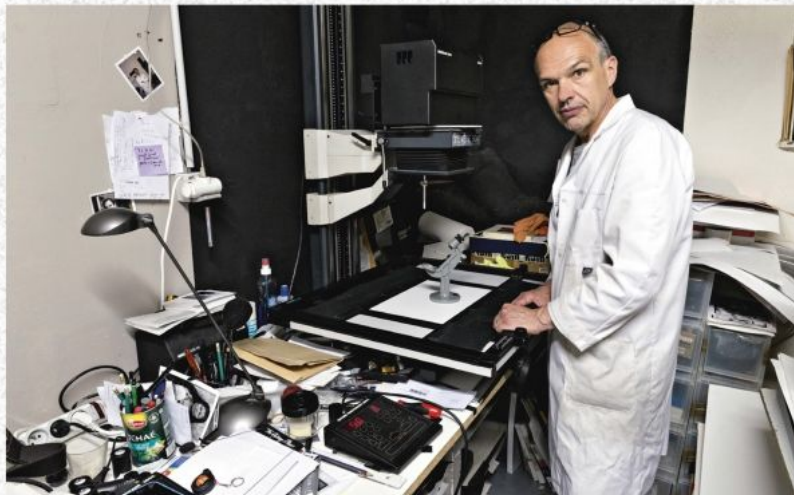
Stéphane Cormier devant son agrandisseur DeVere 504 sur lequel est montée une tête Ilford Multigrade 500.
