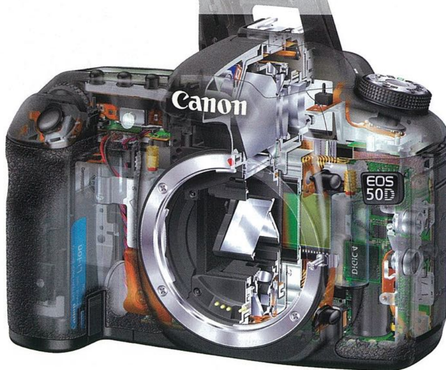
Le capteur, situé derrière le miroir, reçoit la lumière et la convertit en impulsion électrique.
