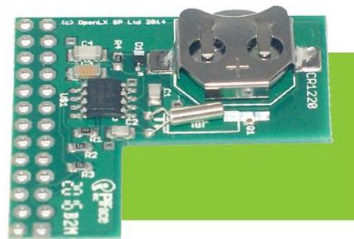
■ Les trous ne sont pas alignés pour forcer le contact
