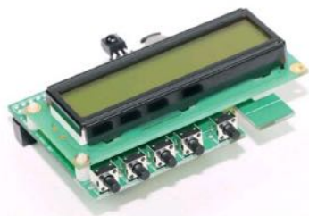
Les boutons de la carte, cinq devant et un switch à l'arrière.
