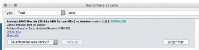
Le support des Arduino à base d'ARM doit être ajouté manuellement.
