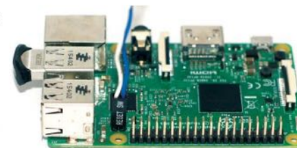
Un bouton reset issu d'un PC monté sur le Raspberry Pi 3.
