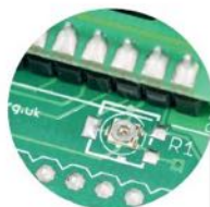
La vis de réglage du contraste.
