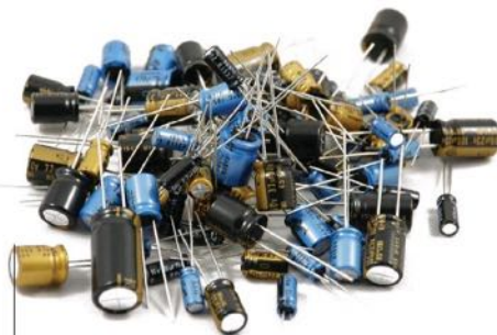
La durée de vie des condensateurs électrolytiques s'effondre lorsqu'ils sont soumis à une température importante.
