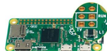
Sur le Raspberry Pi Zero, le header RUN se trouve au niveau des GPIO.
