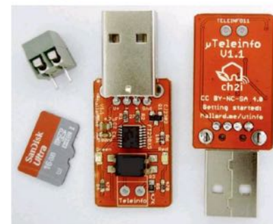
La version USB vendue sur Internet intègre un contrôleur série interfacé en USB et tous les composants nécessaires dans un périphérique très compact.
