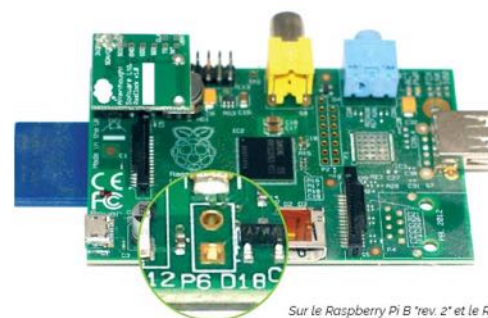
Sur le Raspberry Pi B rev. 2 et le Raspberry Pi A, l'emplacement porte le nom P6 et se trouve à gauche de la prise HDMI.
