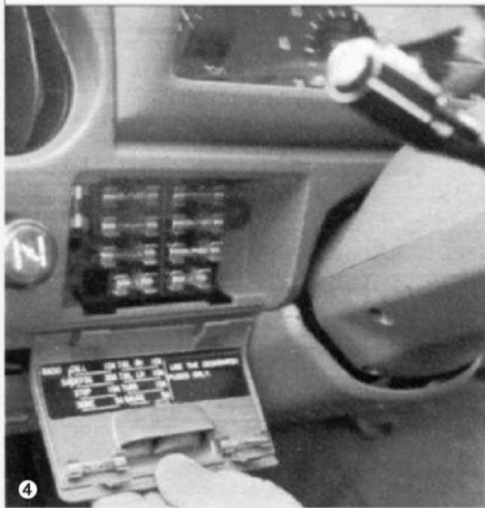
❶ Archiclassique et sans charme, le style de la Tercel n'est pas son meilleur atout... ❷ Ce 4 cylindres tout en aluminium, placé longitudinalement, est un 1 295 cm 3 développant 65 ch DIN à 5400 tr/mn. ❸ La radio est ici proposée en option. ❹ Les fusibles, facilement accessibles, sont faciles à changer.
