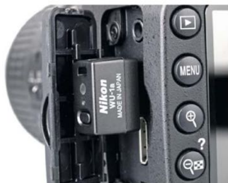
Le transmetteur Wi-Fi WU-1A permet aux reflex Nikon d'accéder aux réseaux sans fil.
