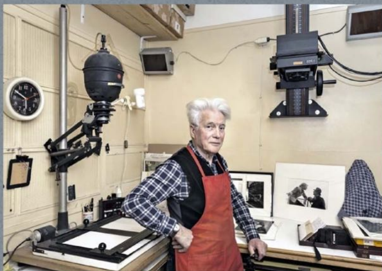
Dans son labo, Philippe Salaün utilise des agrandisseurs Leltz Focomat IC et IIC (à gauche, un IC). Le Zone VI à tête lumière froide et contraste variable, fixé au mur, est très utile pour venir à bout des négatifs contrastés.
