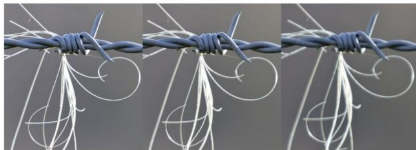
Détail d'une photo à cadrage constant avec le 70-200 mm f:2,8 G2 utilisé seul, avec le TC-X14 et le TC-X20. La perte de qualité est limitée (quoique visible) avec le x1,4 et elle est très marquée avec le x2,0.
