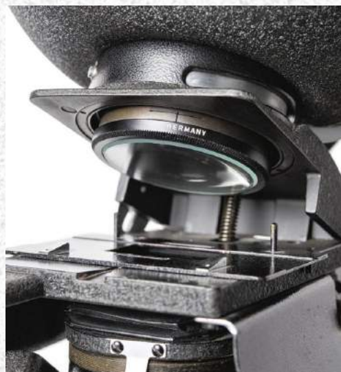
Le condenseur, qui presse le film contre le porte-négatif, est recouvert d'un verre anti-newton.
