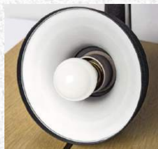
La source de lumière du Focomat est une ampoule opale de 100 ou 150 W.
