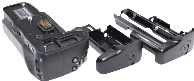
Poignée d'alimentation pour le Pentax K-3. On peut, indifféremment (grâce à deux tiroirs distincts), insérer 6 piles bâton de type AA ou un accumulateur dédié (D-LI90) qui vient en support du principal, situé dans la poignée de l'appareil... ce qui double l'autonomie.
