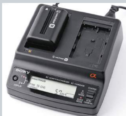
Le chargeur Sony VQ900-AM possède un afficheur complet qui indique les informations pour chaque accumulateur en charge.
