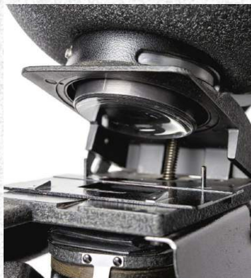
Le condenseur, ici à nu, presse le film contre le porte-négatif. Le système est efficace mais peut provoquer des anneaux de Newton.
