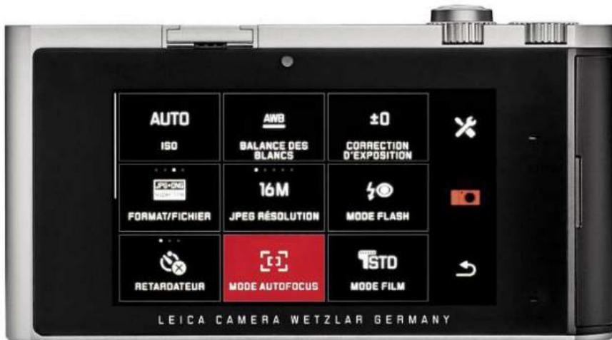
À part les deux molettes affleurantes en bord de capot et le déclencheur, aucune commande physique n'est visible sur cette vue de dos. La navigation s'effectue en tactile sur une belle dalle de 9,4 cm de diagonale, qui réserve un rectangle de 4x7 cm à la visée. À droite, une trappe abrite la baie de la carte mémoire et une unique connexion USB 2.0.
