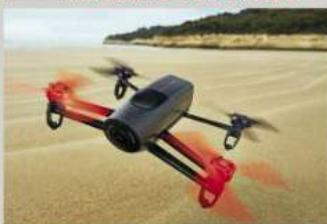
Le drone Bebop du Français Parrot est un quadricoptère ultraléger (400 g) possédant un objectif fish-eye 180° f:2,2 et un capteur CMOS 1/2,3". Il peut réaliser des photos de 14 MP et des vidéos Full HD 1080 avec stabilisation sur trois axes. Avec ses fonctions Wi-Fi et GPS, il peut se piloter jusqu'à 300 m depuis un smartphone ou une tablette. Commercialisation prévue fin 2014. [www.parrot.com](http://www.parrot.com)
