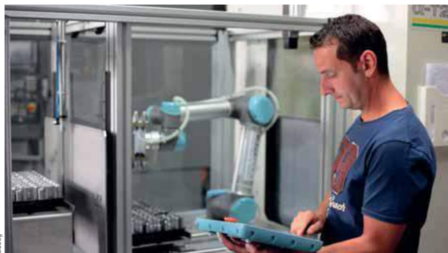
∞ : Programmation de l'UR5 de Universal Robots chez Boog Machining.
