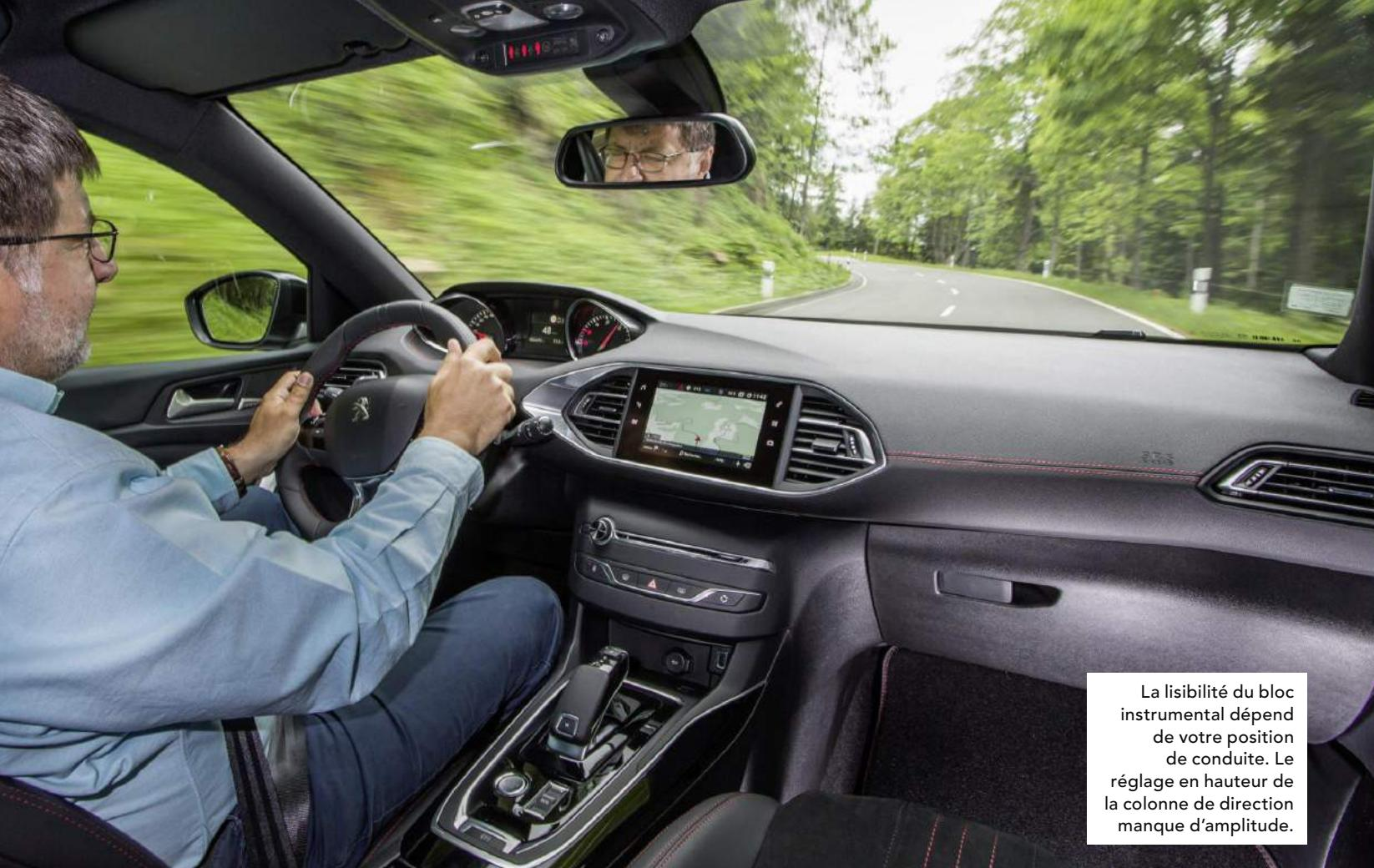
La lisibilité du bloc instrumental dépend de votre position de conduite. Le réglage en hauteur de la colonne de direction manque d'amplitude.
