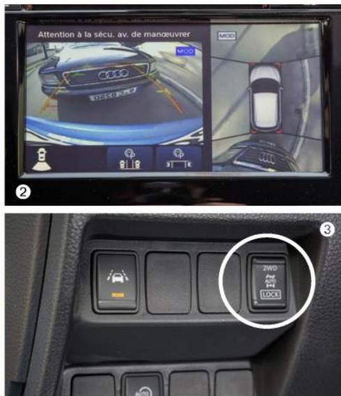
1 Les nouveaux sièges en cuir se règlent électriquement (de série sur Tekna+). 2 La caméra de recul avec vision 360° comprend le Park Assist (pictos en bas à droite) qui permet à la voiture de se garer seule. 3 À l'aide de ce bouton, on peut choisir le type de motricité: aux roues avant ou aux quatre roues.
