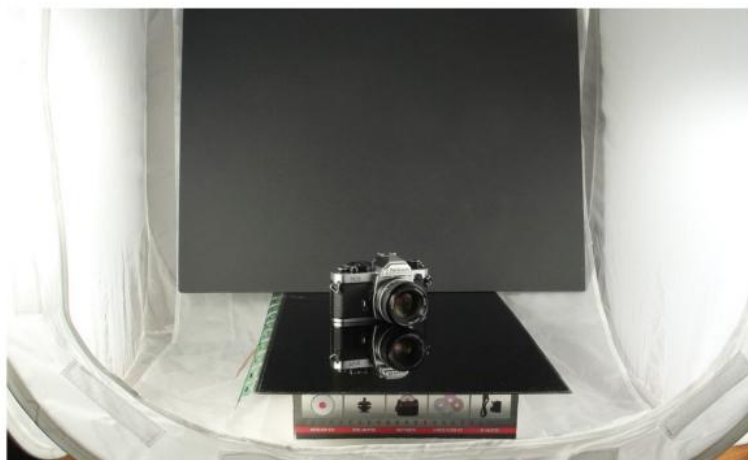
L'objet est éclairé par deux flashes placés sur les côtés à l'extérieur de la tente. Le socle réfléchissant provient d'un écran LCD démonté.
