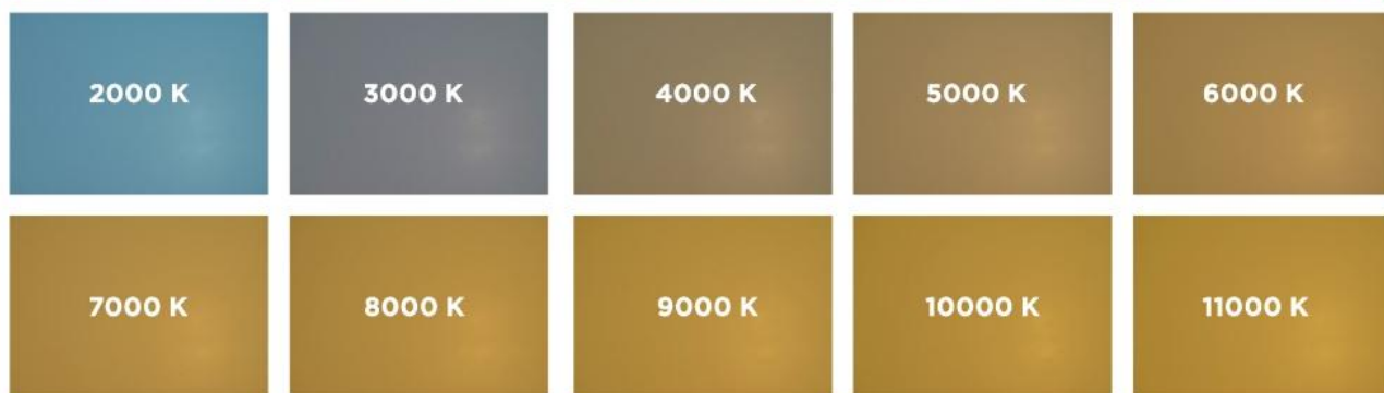
Clichés RAW avec un panneau LED éclairant une surface blanche à différentes températures de couleur (en Kelvin)
