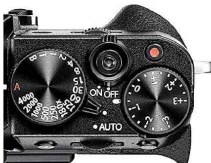
Le temps de pose ou "vitesse" se règle sur l'appareil via une molette, pouvant être graduée comme sur ce Fuji.
