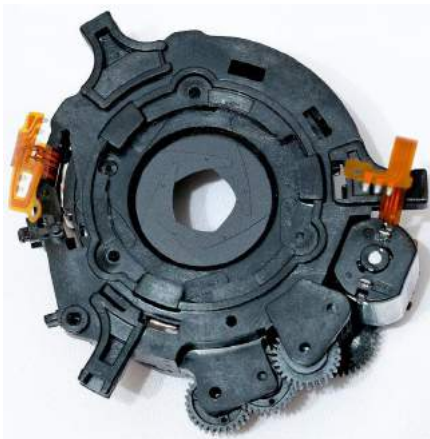
Le diaphragme est un mécanisme circulaire placé dans l'objectif permettant de doser la quantité de lumière.
