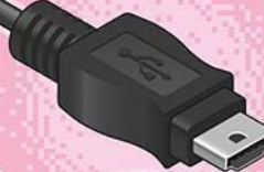
Mini-USB Type A Pour baladeurs, appareils photo (assez peu utilisé).
