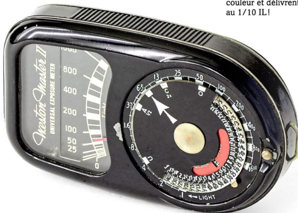
La célèbre Weston Master, avec sa coque en alliage d'aluminium et ses joints d'étanchéité était, après la seconde guerre mondiale, la « Rolls » des cellules au sélénium, avec sa précision de l'ordre de 1/10 IL... bien suffisante pour les négatifs noir et blanc de l'époque.
