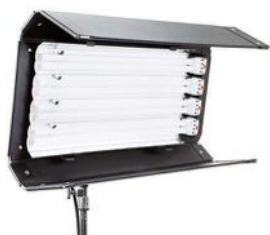
Ce « Kinoflo » (marque spécialisée dans les panneaux de tubes fluo) est constitué de 4 tubes fluorescents de 55 W chacun. On peut choisir des tubes d'une TC de 3200 K ou de 5500 K... avec un IRC de 95 !
