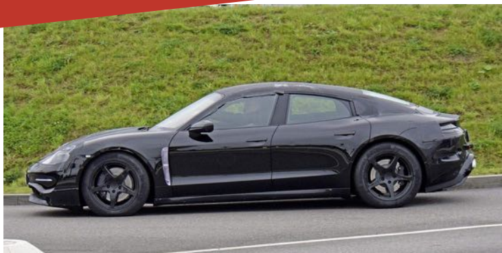
Les batteries seront logées sous le plancher et la transmission se fera aux quatre roues, grâce à un moteur électrique placé sur chaque essieu.
