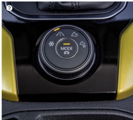
❶ Seul diesel disponible pour le moment, le 2.0 TDI de 150 ch est tonique et sobre à la fois. ❷ Cette molette agit sur la transmission 4Motion et permet de s'adapter aux conditions d'adhérence du terrain. ❸ La boîte auto DSG7 reste une référence en termes de douceur et de réactivité.
