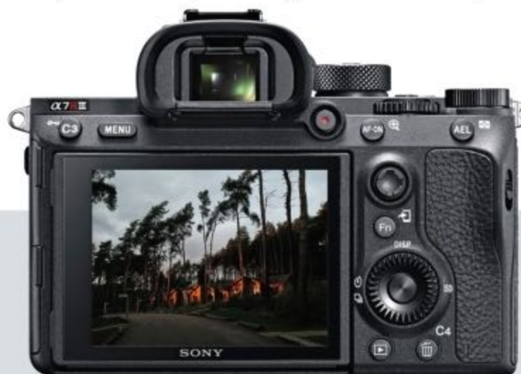
Le 7R III reprend le mini-joystick et l'EVF de l'Alpha 9.
