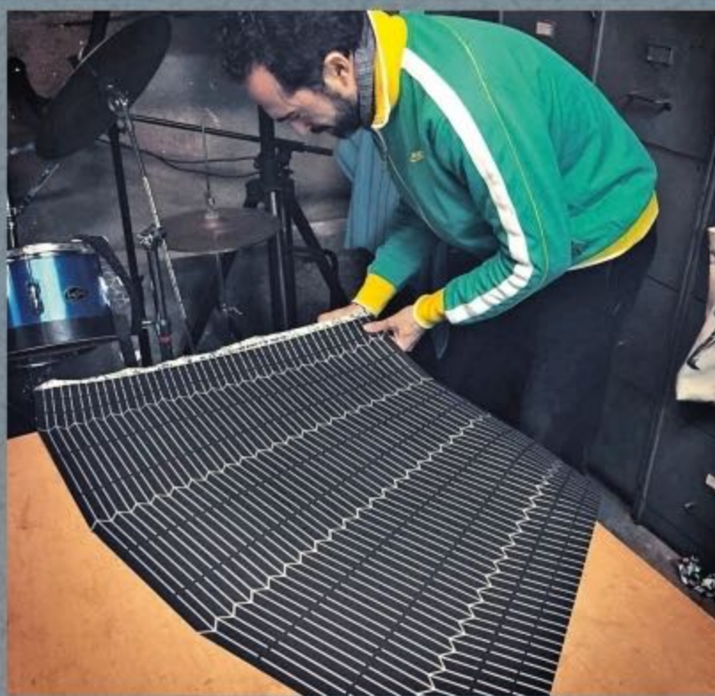
Le "pliage à 4 mains" du soufflet est une opération délicate... La batterie, au fond du garage, n'est pas une réalisation Woodyman !
