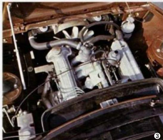
① Cette proue très plongeante dispose, aux avant-postes, d'un super pare-chocs "à l'américaine" pouvant absorber un impact sans dégâts jusqu'à 8 km/h. ② La TR7 surprend sous cet angle, avec son arrière massif et tronqué, rompant avec la forme plus fluide de l'avant. ③ Issu de la Dolomite, la TR7 reçoit un 4 cylindres 2.0 8 soupapes développant 105 ch DIN. ④ Pour gagner quelques chevaux, le ventilateur possède un embrayage visqueux qui ne l'entraîne plus à grande vitesse.
