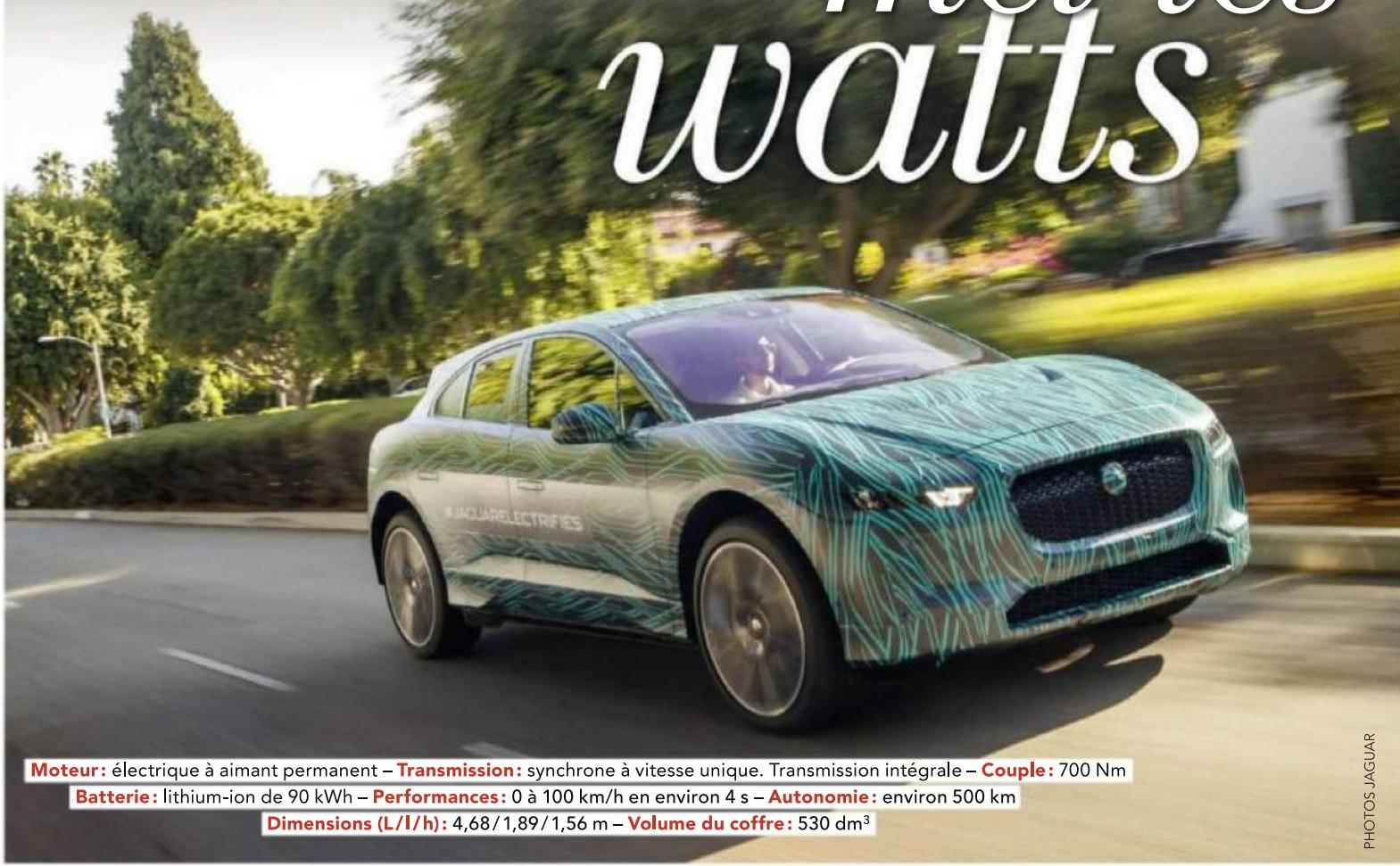
**Moteur:** électrique à aimant permanent – **Transmission:** synchrone à vitesse unique. Transmission intégrale – **Couple:** 700 Nm
