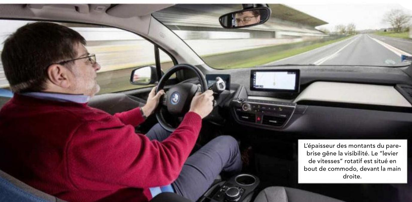
L'épaisseur des montants du pare-brise gêne la visibilité. Le "levier de vitesses" rotatif est situé en bout de commodo, devant la main droite.
