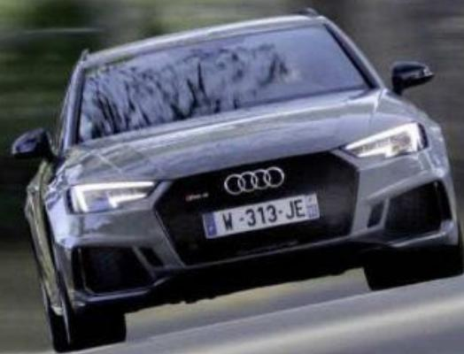
La face avant de la RS4 se distingue notamment par les ouvertures bées du bouclier, permettant d'alimenter le V6 biturbo en air frais.
