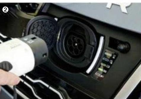
1 Avec les suspensions pneumatiques variables, le confort de suspension est remarquable. Le Range P400e s'accommode davantage d'une conduite en souplesse. 2 Sur une prise domestique, le Range "fait le plein" en 7 heures. Il recharge évidemment plus rapidement sur une borne rapide de 32 A: 2 h 45 mn.
