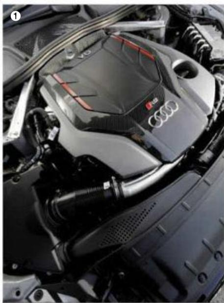
❶ Utilisé sous le capot des Porsche Panamera et Cayenne, le V6 fait appel ici à deux turbos et à un système d'échangeur air/eau. La pression de suralimentation est portée à 1,5 bar. Le souffle des turbines se fait entendre à pleine charge, mais ne masque heureusement pas le mélodieux feulement du 6 cylindres. ❷ Comme n'importe quel break A4, la RS4 compte 5 places et un vrai coffre.
