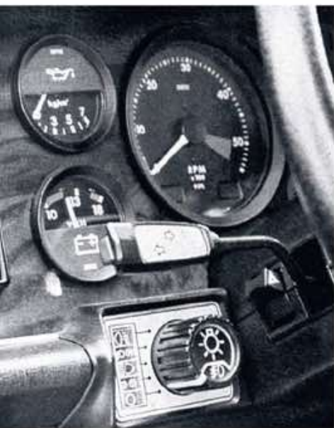
Un contacteur rotatif est destiné à tous les éclairages extérieurs.
